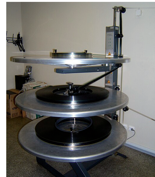
Exemple d'un système de plateaux, proche de celui utilisé au cinéma. On aperçoit les poulies qui guident le film vers le projecteur
